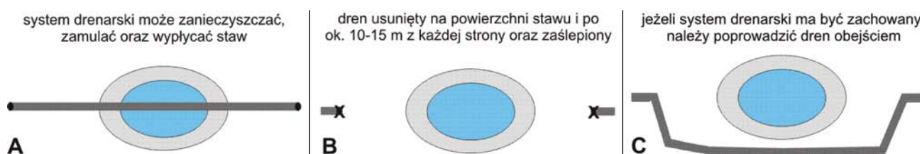
Ryc. 45. Problemy z systemem drenarskim (MPP 2011, zmienione)
